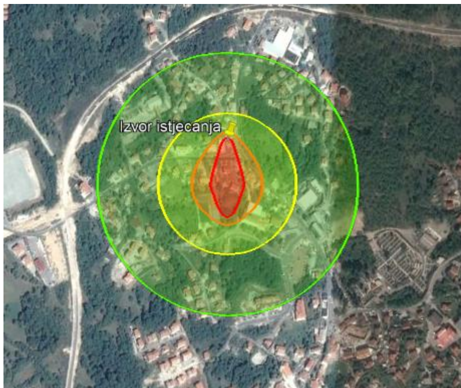
Slika 19. Zone ugroženosti uslijed eksplozije plinske faze benzina
